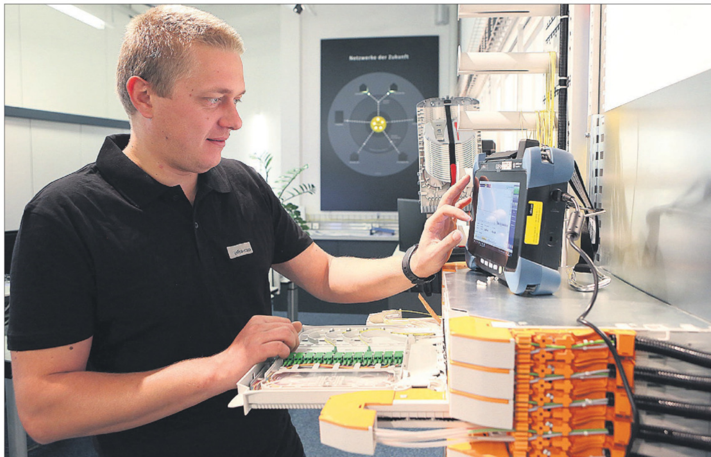
Christian Wichmann, Projektmanager Glasfaserprojekte, macht eine Qualitätsanalyse einer Glasfaserstrecke.
